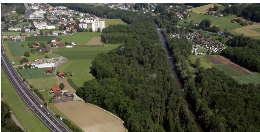
Gestrecktes Gerinne bei Oberflamatt. (Foto Flussbau AG SAH)
