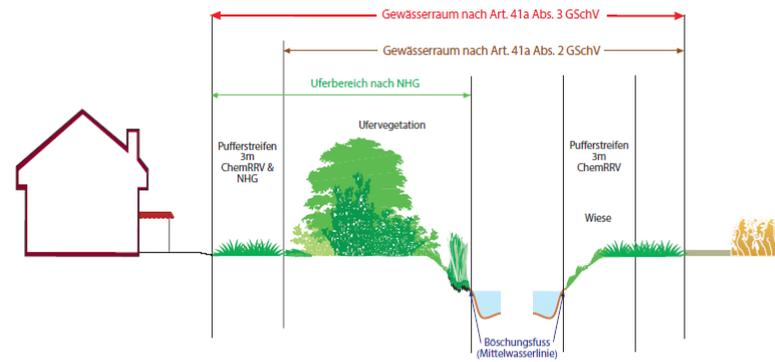
Abbildung 3: Uferbereich nach NHG und Pufferstreifen nach ChemRRV sind Teile des Gewässerraums
